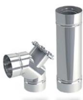
Einwandige, druckdichte Systemabgasanlage aus Edelstahl. Die innovative konische Verbin-dungstechnik des Innenrohres (metallische Flächendichtung) gewährleistet eine druckdichte Verbindung bis max. 5000 Pa (H1) bei einer maximalen Betriebs-temperatur von 600°C. Das System ist geeignet für Montagen im bestehenden Schacht sowie als Verbindungsleitung.
