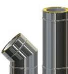
Das ist ein Schornsteinsystem für Stromaggregate MKDT-U. Dank der speziellen Sicken am Mantelrohr und hochtemperaturbeständiger Dichtung wird ein maximaler Überdruck H1 bis 5000 Pa gewährleistet. Die Abdichtung im Bereich des Außenrohres gewährleistet eine freie Ausdehnung des Innenrohres, was bei hohen Temperaturen sehr wichtig ist.
