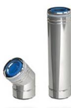
MKPK ist eine hochwertige konzentrische Systemabgasanlage mit Innenrohr PP (Polypropylen) und Außenmantel Edelstahl. Sie wird im Außen- und Innenbereich eingesetzt zur Ableitung der Rauchgase von Brennwertfeuerstätten und BHKWs bei raumluftunabhängiger Betriebsweise. Die Montage ist OHNE Außenklemmband möglich. Das Innen- sowie das Außenrohr wird werkseitig mit einer Dichtung versehen.
