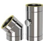
MKDT ist eine Schornsteinsystem für (Not-)Stromaggregate. Dank der speziellen Sicken am Außenrohr und hochtemperaturbeständigem Silikon wird ein maximaler Betriebsdruck von 5000 Pa gewährleistet. Die Abdichtung im Bereich des Außenrohres gewährleistet eine freie Ausdehnung des Innenrohres, was bei hohen Temperaturen sehr wichtig ist.
