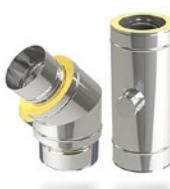
Doppelwandige, druckdichte Systemabgasanlage aus Edelstahl. Die innovative konische Verbindungstechnik des Innenrohres (metallische Flächendichtung) gewährleistet eine druckdichte Verbindung bis max. 5000 Pa (H1) bei einer maximalen Betriebstemperatur von 600°C. Das System ist geeignet für Montagen als Außenwandsystem sowie als Verbindungsleitung.
